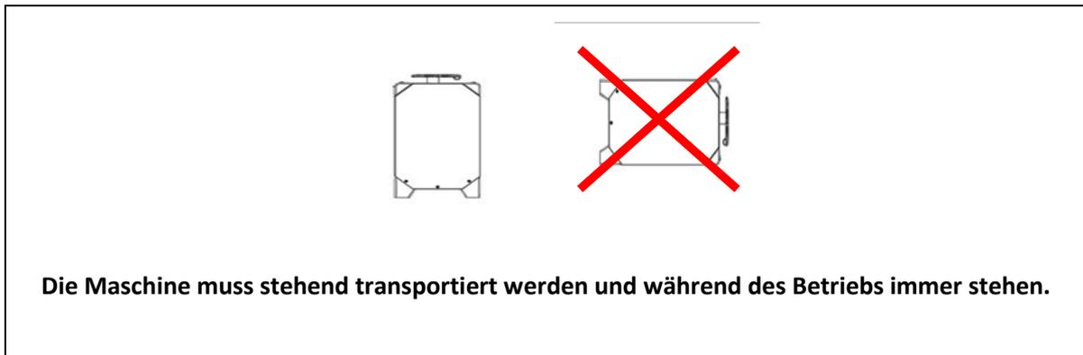
1. Stellen Sie den Trockner auf einen ebenen Untergrund, auf dem er nicht umfallen kann. Die Unterlage sollte nicht wasserempfindlich sein, da mit Sicherheit Wasser verschüttet wird, wenn z. B. am Kondenswasserschlauch gearbeitet wird.
